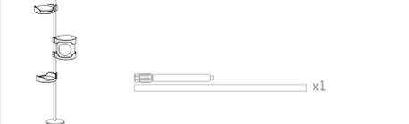
將D' 與D柱結合旋緊後，再將整支D柱套入C柱。
