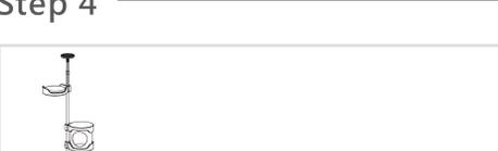
將D柱整支拉起，直至頂盤抵住天花板，並確認整支支柱與地面和天花板垂直後，再以六角扳手將四顆螺絲鎖緊。
